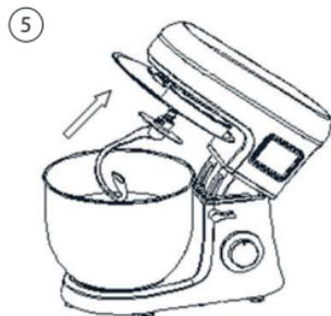
9. Поверните чашу (1) по часовой стрелке. Снимите насадку, вращая ее по часовой стрелке. Снимите крышку чаши в направлении, указанном стрелкой. Рис. 6
